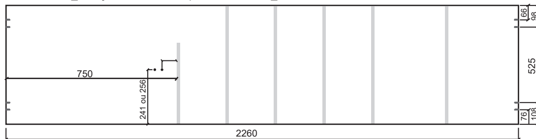
5. Divisória A_Furação Face voltada p/ Lateral Direita_2260X525X15mm
