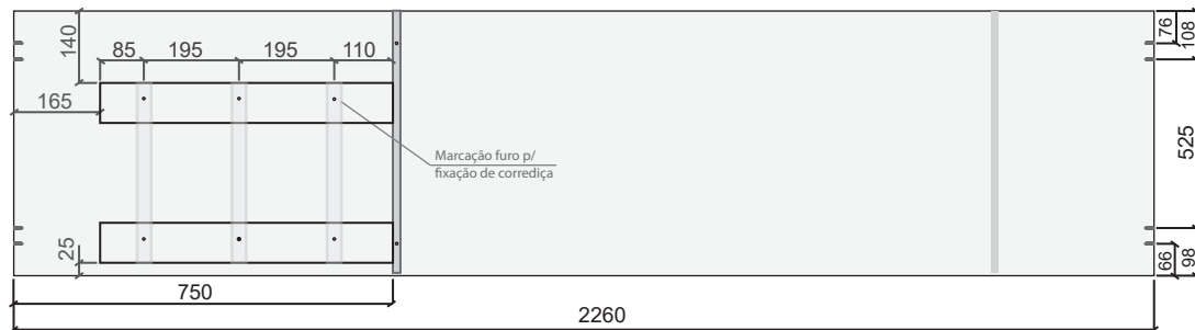
5. Divisória A_Furação Face voltada p/ Lateral Direita_2260X525X15mm
