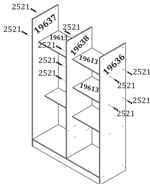
**6** Fixe o tampo (19640) nas cavilhas (2473) da divisão (19638). Em seguida, com o parafuso (2521) fixe o tampo nas laterais (19636/19637).
