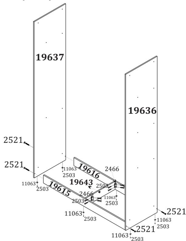
**2** Fixe a base (19639) nas laterais (19636/19637) com o parafuso (2521) e em seguida, fixe nos rodapés (19615/19616) utilizando o parafuso (2505).
