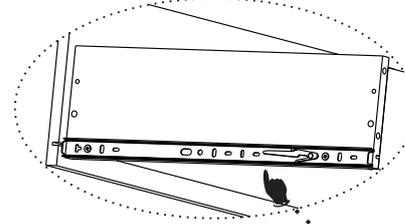
**Fixar a corredeira zerando na parte de baixo da lateral de gaveta, posicione e fixe diretamente com os parafusos (2503).**
