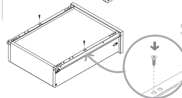
Utilize os furos de regulagem e ajuste a corrediça para a esquerda ou para a direita, conforme sua necessidade.
