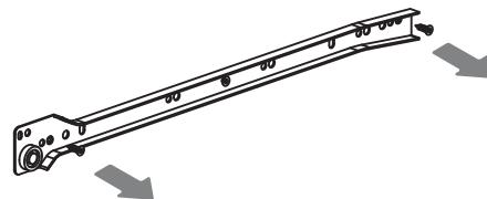
Fixe os parafusos das extremidades na furação com regulagem da corrediça, sem aperto total. Nivele a corrediça conforme a necessidade e aperte totalmente os parafusos.
